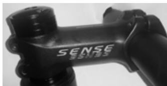
Guidão na altura mais baixa: espaçadores acima do suporte de guidão
